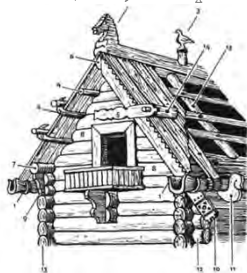
Схема устройства кровли (реконструкция М.В. Красовского): 1 желоб 2 охлупень 3 станик 4 слеза 5 огниво 6 Князовая слеза («княси») 7 повальная слеза 8 санец 9 повал 10 причелина 11 курица 12 пропуск 13 бык 14 гнет
