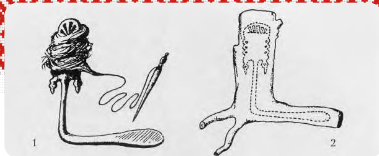
Севернорусская прялка из копани: 1 - общий вид; 2 - схема изготовления.
